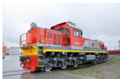
маневровый тепловоз ТЭМ28
